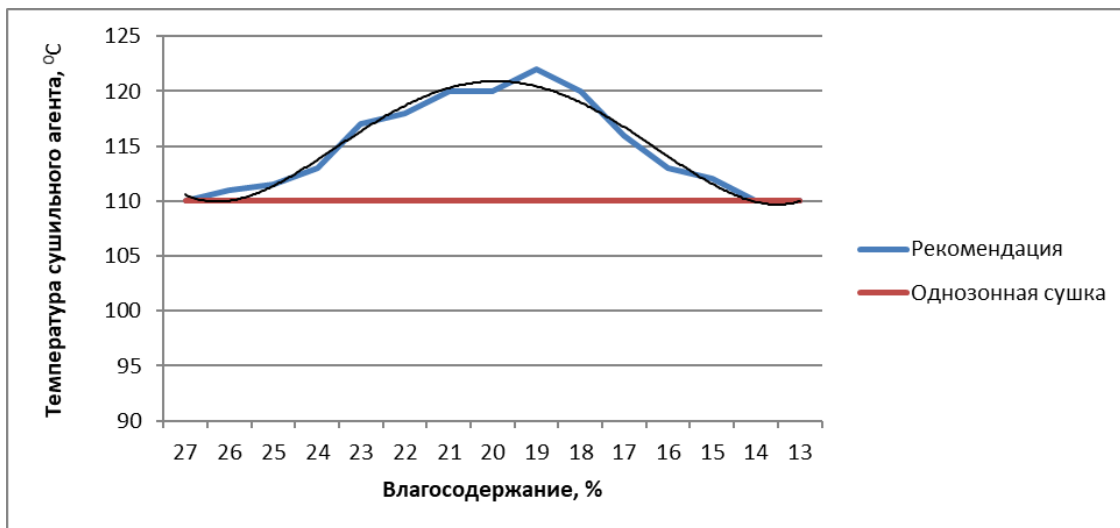
Рисунок 1 - График рекомендуемой температуры сушильного агента для мягких сортов пшеницы
